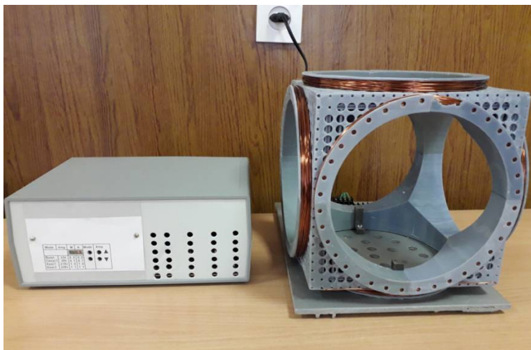
Рис. 1. Аппаратно-программное устройство моделирования вариаций магнитного поля Fig. 1. Hardware and software device for simulating magnetic field variations
