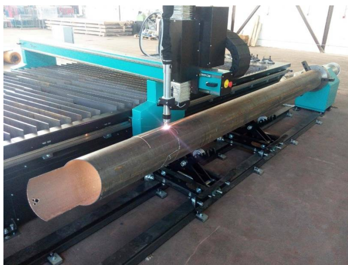
Рис. 1. Примерный вид станка с ЧПУ плазменной резки после модернизации
