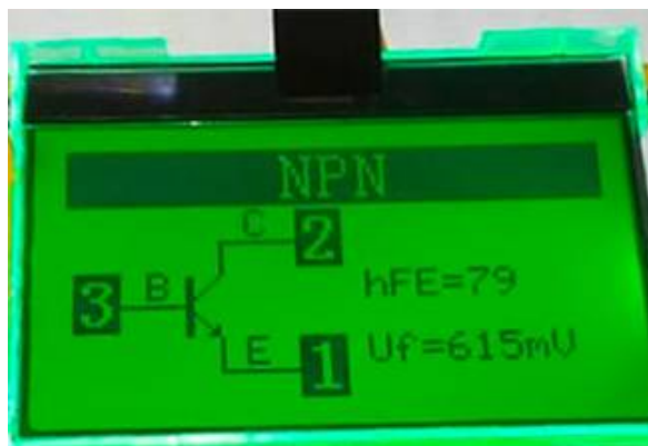
Рис. 3. Измерение параметров транзистора КТ817Г
