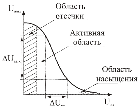
Рис. 6.8. Передаточная характеристика усилителя на БТ по схеме ОЭ
